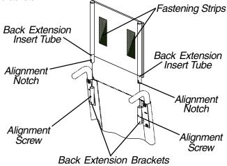
FIGURE 2 - INSTALLING THE BACK EXTENSION
